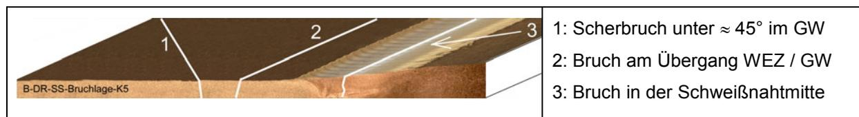
Abbildung 4-12: Bruchlagen im Querzugversuch.
