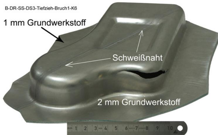
Abbildung 5-70: Bruch im Grundwerkstoff mit einer Blechdicke von 2 mm.
