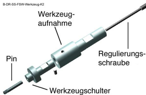
Abbildung 2-2: FSW-Werkzeug [74, 75].
