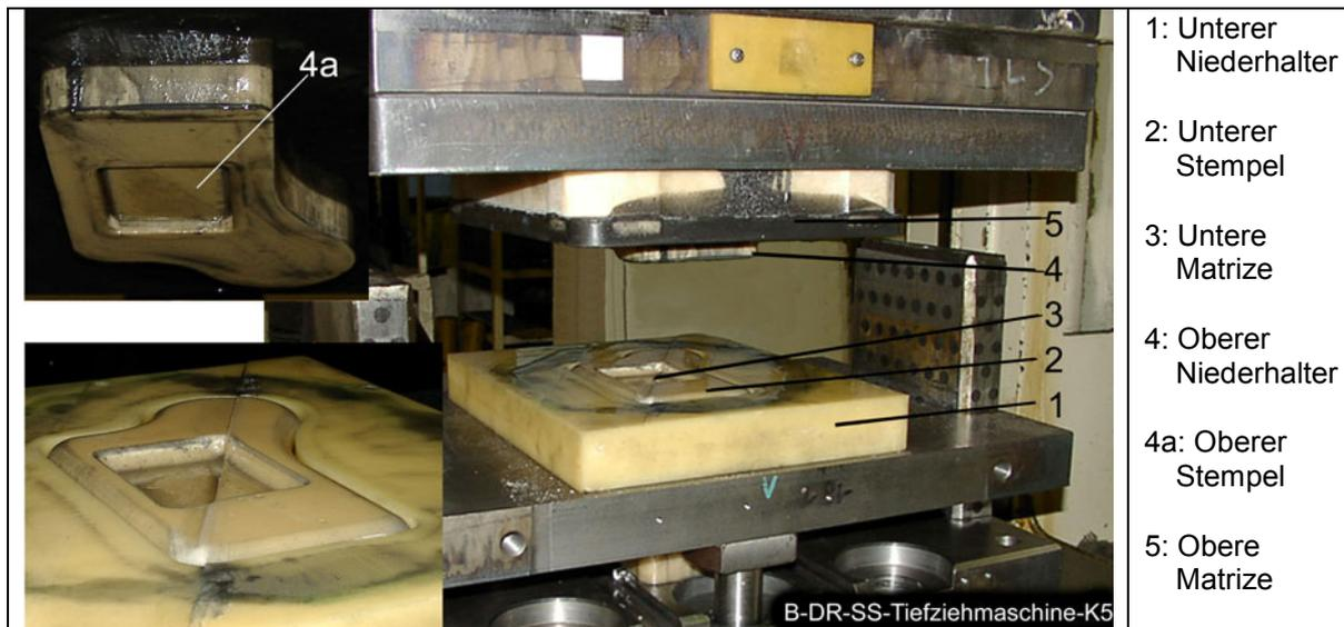
Abbildung 4-24: Tiefziehwerkzeug.
