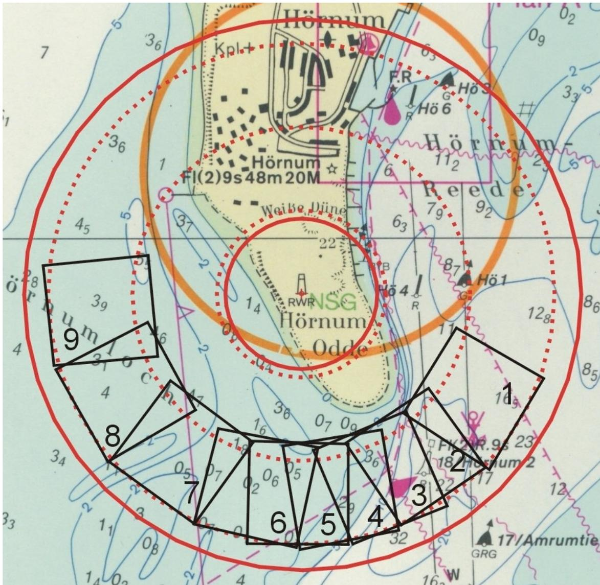
Abbildung 11: Karte der 'Hörnum Odde' mit den WaMoS II-Analysefenstern; Maßstab 1:25000 (Quelle: BSH 2005).
