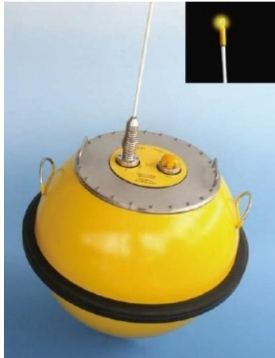
Abbildung 9: 'Directional Waverider'-Boje zur Seegangsmessung (Quelle: Datawell).
